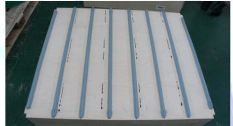
Aplicación de resina encima de los paneles de aislamiento para los barcos de transporte de gas líquido ( tipo LNG)
